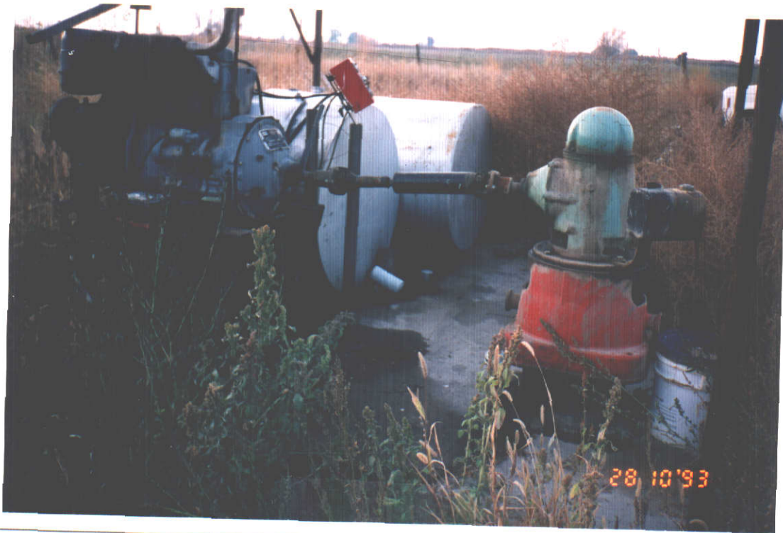
Deutz motor + 40 HP Inmanville pump
